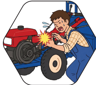
회전하는 벨트에 손이 말려들어가 손가락 절단 사고 발생
