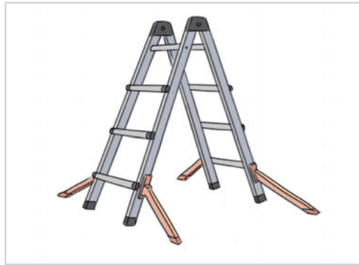
〈기존 사다리에 버팀대 설치〉
