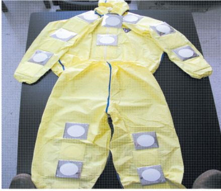
그림 6. 농약 노출을 측정하기 위한 신체부위별 패치 부착
