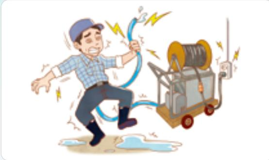
계사 물청소 도중에 고압분무기 모터 수압 조절을 위해 고압분무기 조작 중 감전사고로 생명을 잃은 사고가 발생함. 사고 발생 전에 계사보수를 위해 갈비늄(Galvalume) 설치 과정에서 전선 피복이 손상되어 노출된 상태에서 물청소로 인해 전기가 전도되어 작업자에게 감전사고로 이어진 것으로 추정되는 재해임
